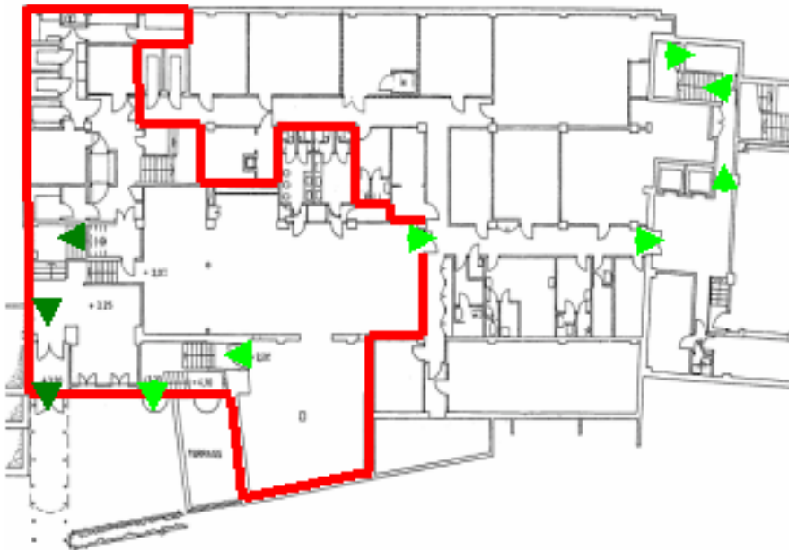
Figur 21 Planskiss över diskotekets källarvåning (utformning 4). Tjocka linjer illustrerar brandteknisk avskiljning mot annan verksamhet.
