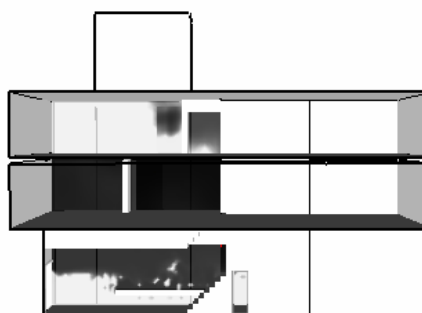
Bild 7.3 Det svarta som syns mot väggarna är då sikten är för dålig för att utrymning skall ske tillfredsställande. Bilden är tagen efter 96 sekunder, d.v.s. direkt efter kritiska förhållanden har uppstått på tredje våningen.
