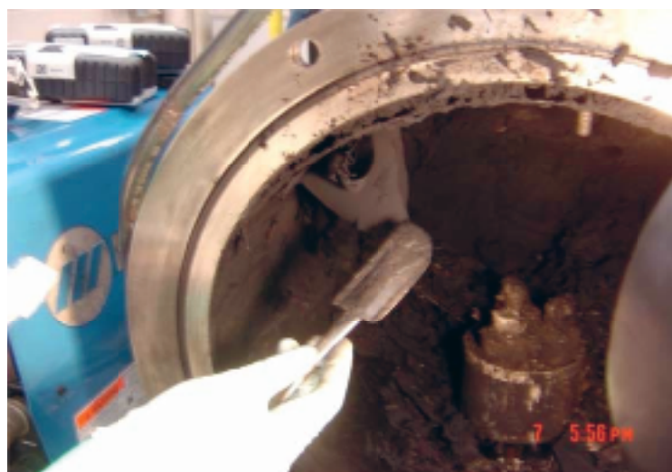
Figur 4. Manuell överföring av kolnanorör från produktionskärlet (med tillstånd av PA Schulte, National Institute for Occupational Safety and Health [NIOSH]).
