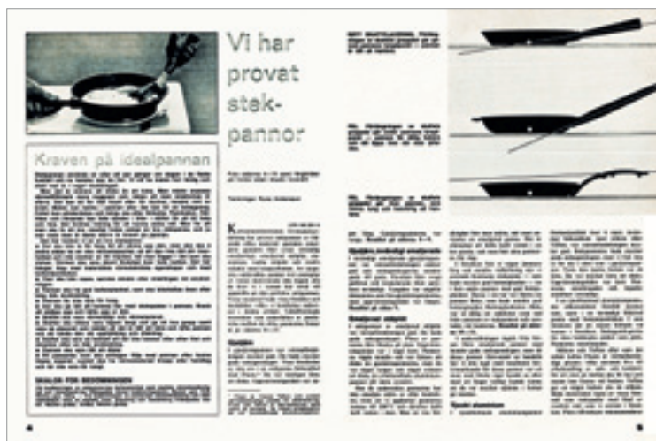
I ett stekpannetest från 1966 låter man materialet breda ut sig på 12 sidor. Bland annat visas en skiss över hur stekpannans skaffet bör vara placerat; den översta modellen var den bästa. ("Vi har provat stekpannor", Råd & Rön nr 9/66, s. 4–15.)
