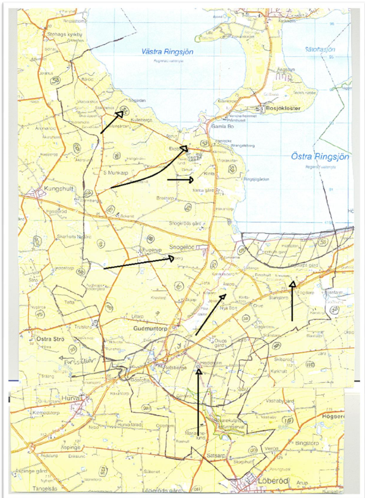
Figur 1: Karta över södra Höör. På kartan finns akvifärrerna Finnshult och Rolsberga uttridade. Utritat på kartan är även pilar som visar den generella flödesriktningen för ytvattnet. © Lantmäteriet, i2012/927
