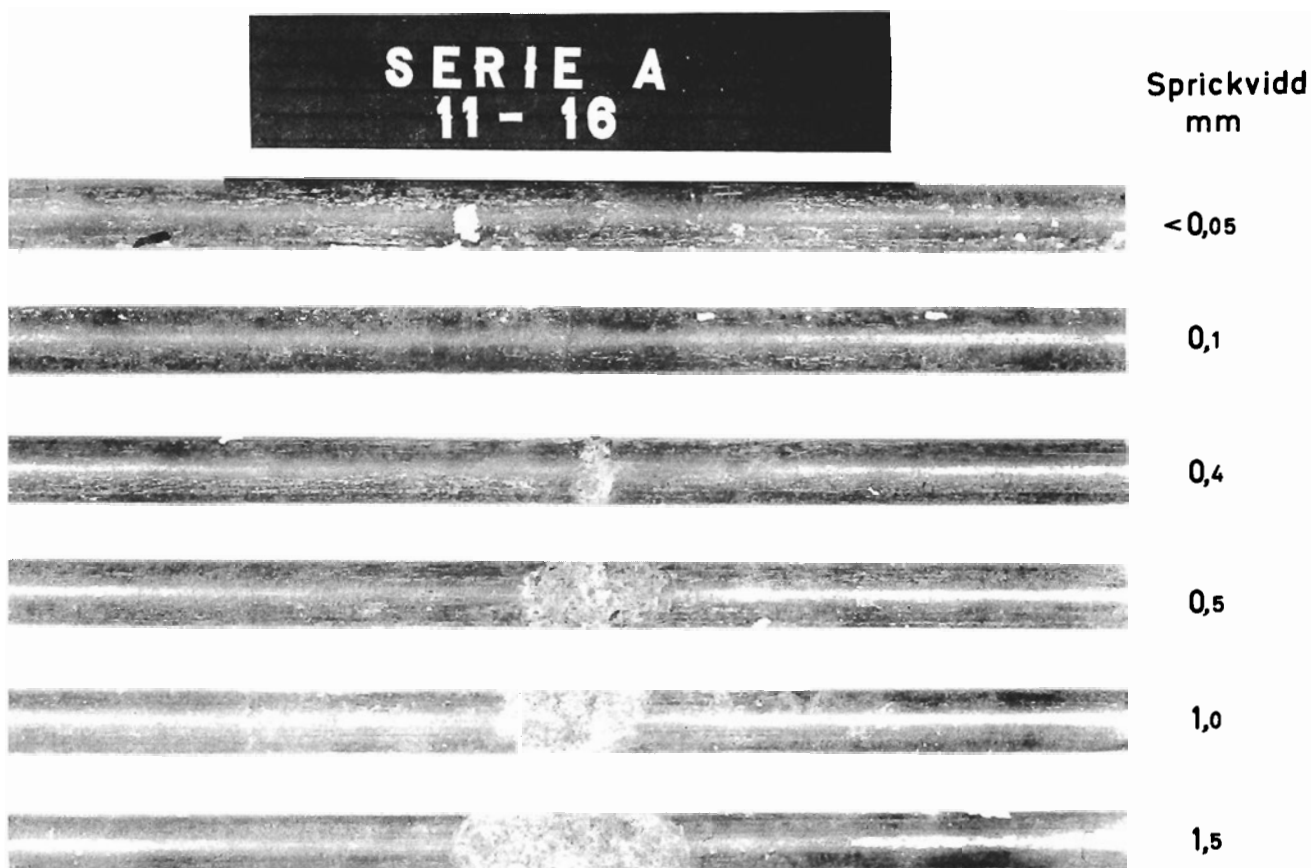
Fig 28. Inverkan av ökande sprickvidd på utbredningen av korrosionen vid sprickorna.
