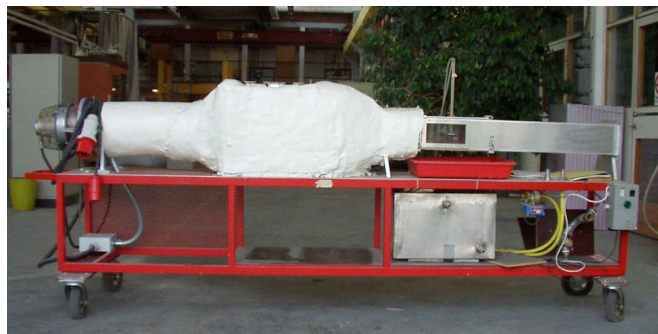
Figur 2. Den vindtunnel som används vid station 1
