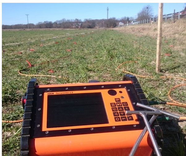
Fig. 16: Instrumentet ABEM Terrameter LS som användes vid resistivetsmätningarna. Tillsammans med två elektroder för nedslagning i mark. Foto: Jonas Schönström
