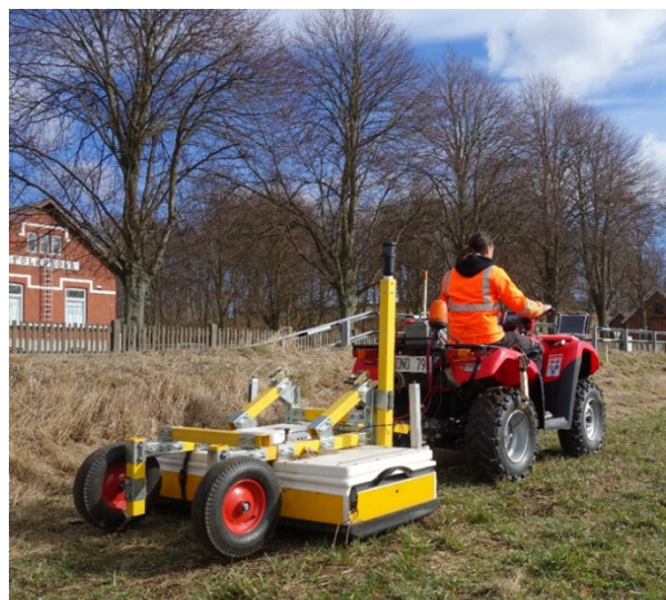
Fig. 14: MIRA -Systemet som användes för markradarmätningarna © Guideline Geo
