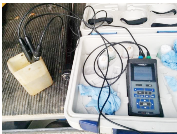
Figur 3.1. Provtagningsutrustning för fältprovtagning av temperatur, pH, syre och konduktivitet.
