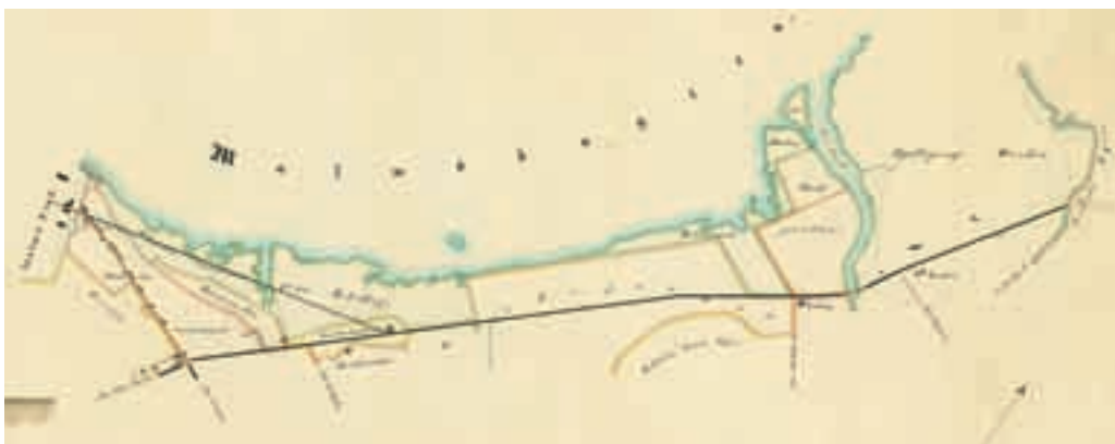
Bild 101. Bilderna tillhör en av fyra skisser på den projekterade chaussén mellan Malmö och Hurva. Notera att träden skall planteras mellan väg och dike för att inte inkräkta på åkermarken. Källa: Beijer 1847.
