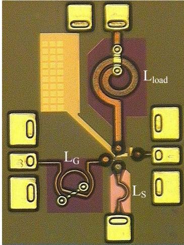
Fig. 2 . Photo of 15 GHz LNA
