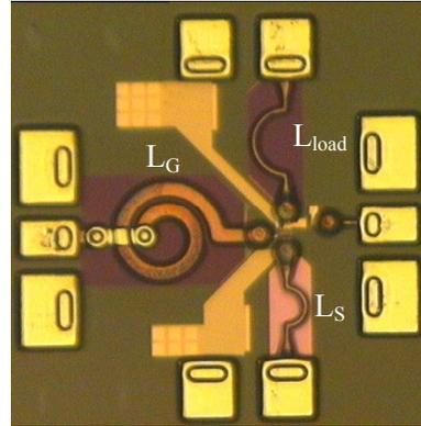
Fig. 3 . Photo of 20 GHz LNA
