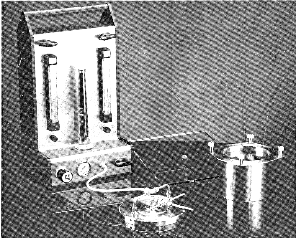
Figur 3.3. Utrustning för mätning med Field and Laboratory Emission Cell (FLEC). Massflödesmätare (till vänster), FLEC mätcell (i mitten) och underdel till mätcellen för mätning på material med ojämn yta (till höger).
