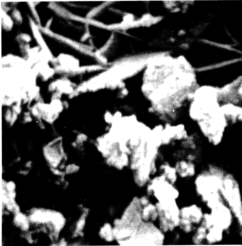
Fig 1.3 Elektronmikrofotografi av strukturen i en porvägg i gasbetong (Göteborg Siporex, \gamma = 0,5 \text{ kg/dm}^3 ) se kommentarer i avsnitt 1.4. (Purins & Linden (67))
