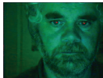
Figur 22. Ett annat Minimeter -experiment. Datorns program följer blicken (de röda datorgenererade markeringarna). Med enkel och billig teknik kan blickpekning (med låg upplösning) kanske användas för att t.ex. svara Ja eller Nej .
