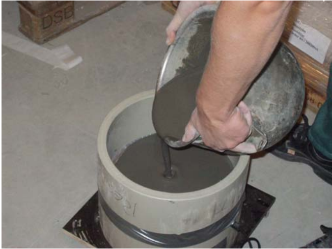
Figur 7.4 Applicering av avjämningsmassa på betongprover.
