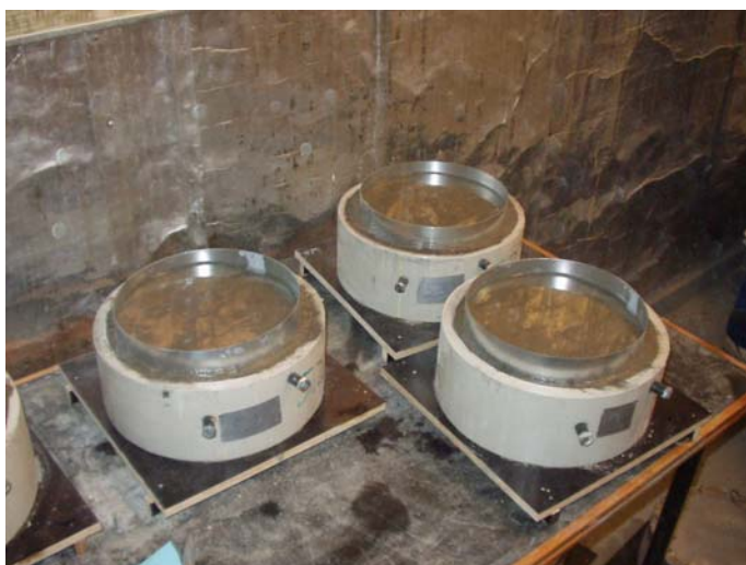
Figur 5.5 Provkroppar med vattenfyllda plåtrör.
