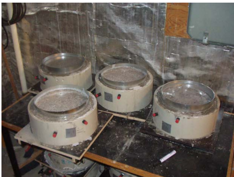
Figur 6.1 Provkropparmed vattenbassänger till vatteninsugningsförsök.
