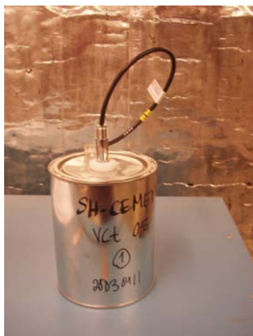
Figur 4.2 Provkropp för mätning av självuttorkning.
