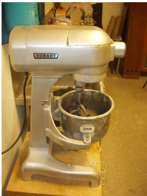
Figur 7.3 Blandning av avjämningsmassa i Hobart-bruksblandare.
