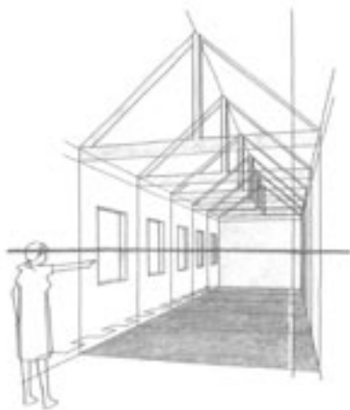
Bild 4: Brukarperspektiv innebär att byggnaden återges i ögonhöjd utifrån betraktarens position (Lockard 2001).
