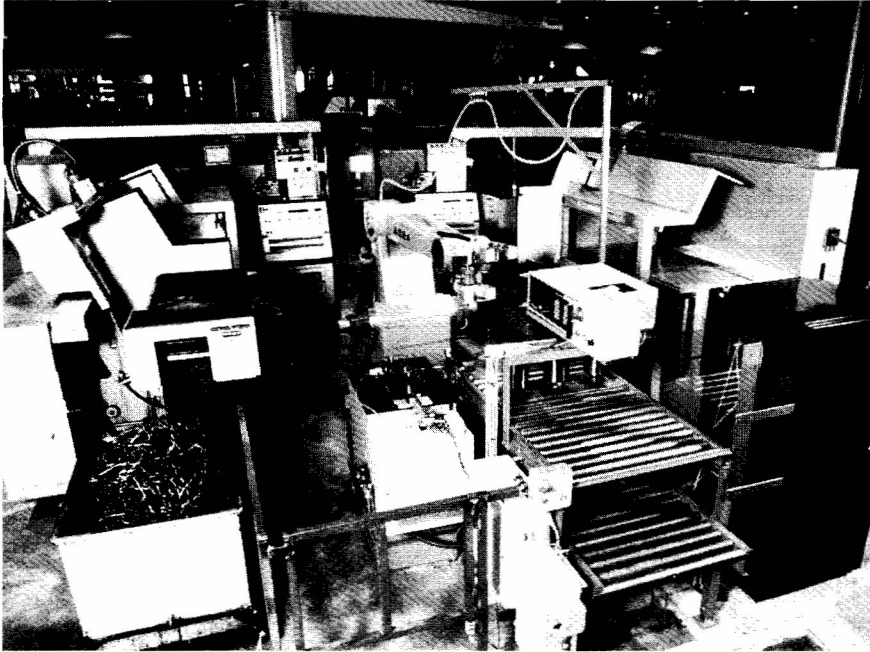
Bild 3. Flexible Drehzelle (Werkfoto: ABB Asea Brown Boveri, Västerås, Schweden und Friedberg/Hss.)
