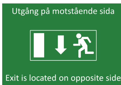
Figur 9. Utrymningsskylt i vägtunnel.
