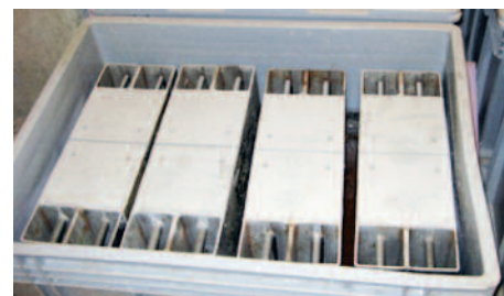
Figur 7: Exponering. Vänstra bilden: Typ 1, nedsänkta i vatten. Högra bilden: Typ 3, kapillärsugning från sprickfri överyta.
