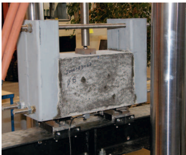
Figur 4: Prov under tillverkning av böjspricka.
