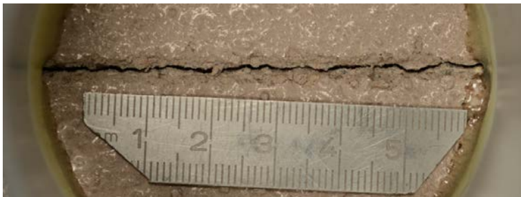
Figur 2.1 Bild av mätområdet med referenslängd (stållinjal).
