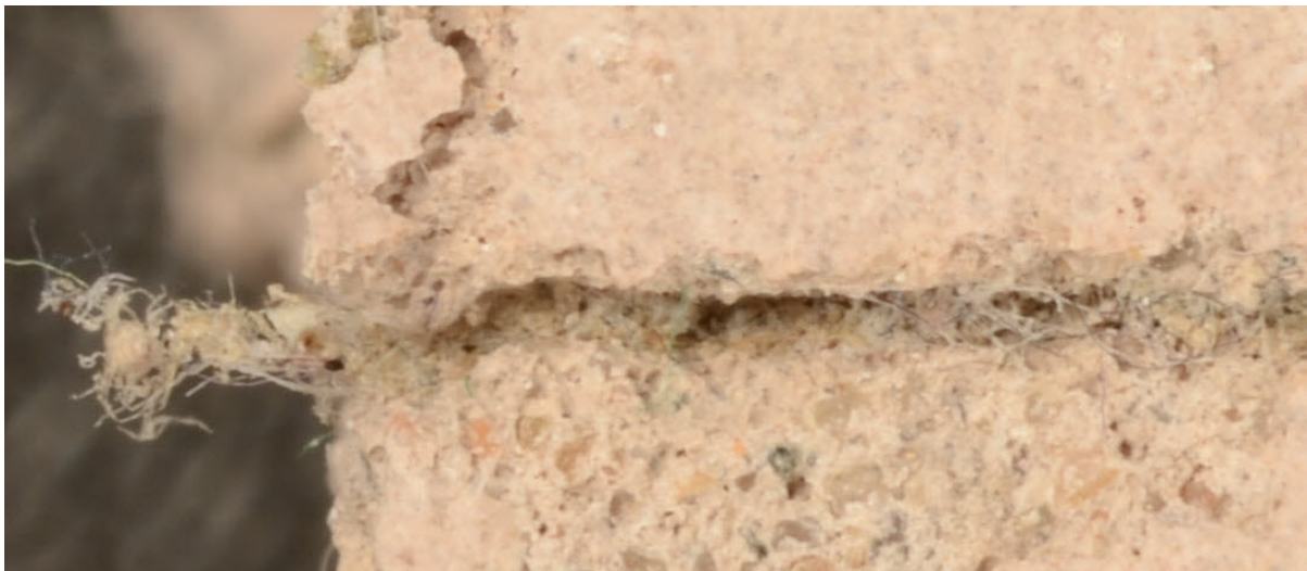
Figur 1.12 Sprickan visad i plan. Provkroppen är delad vinkelrätt sprickans riktning, därav en del av det nybildade materialet som fanns på den andra delen sticker ut till vänster.
