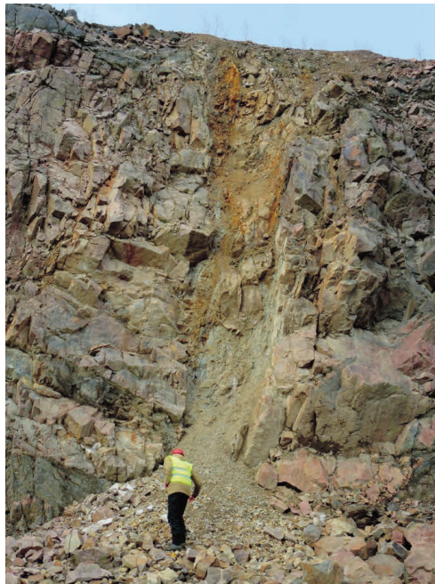
Figur 2. Exempel på en vertikal vittrad zon i stenbrottet som ligger intill undersökningsområdet. Lägg märke till den starkt uppspruckna karaktären hos bergmassan som omger den vittrade zonen, vilket är typiskt för berget som är exponerat i stenbrottet.
