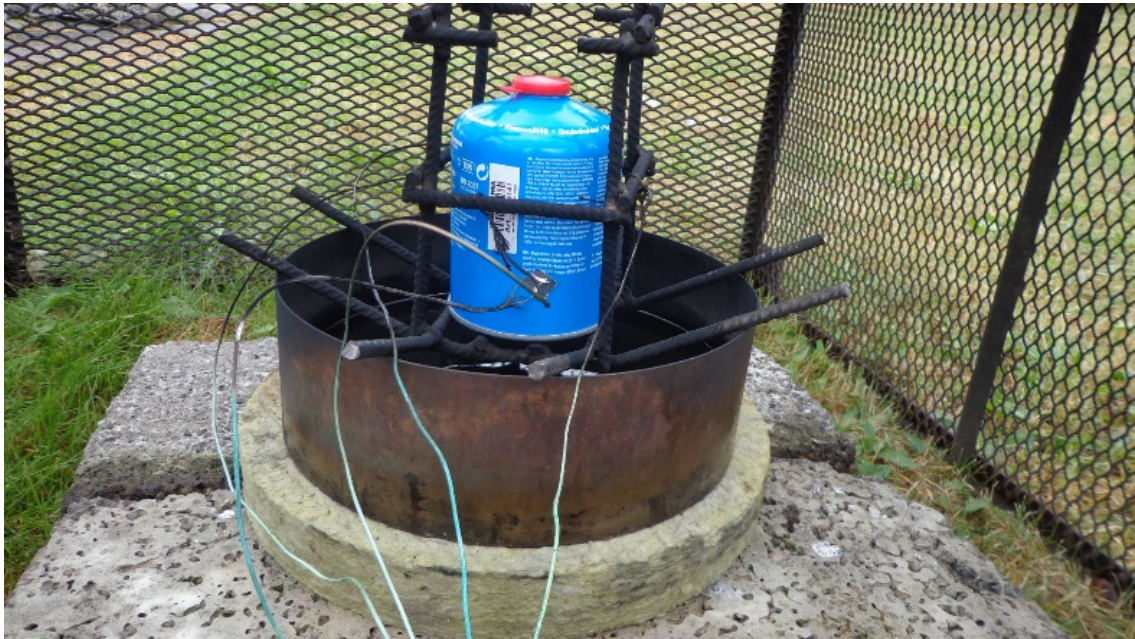
Figur 11. Provuppställning med gasolbehållare 450 gram.
