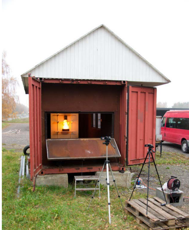
Figur 4. Butiksuppställning i container. Brandprovning just startat.
