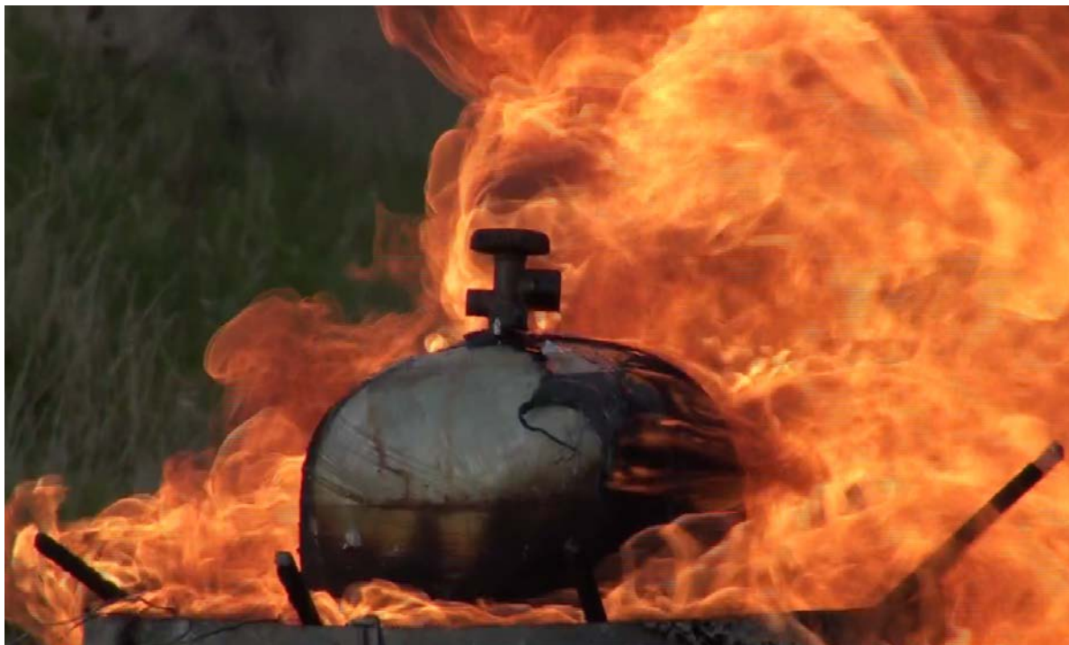
Figur 33. Anslutningsdelen har kantrat.
