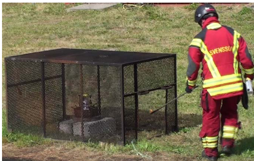
Figur 3. Antändning av pölbrand.
