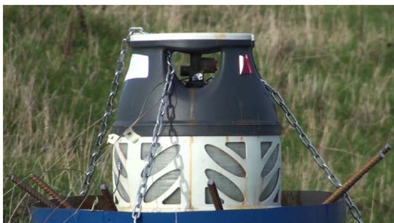
Figur 30. Försökssupställning med gasolbehållare PC5.
