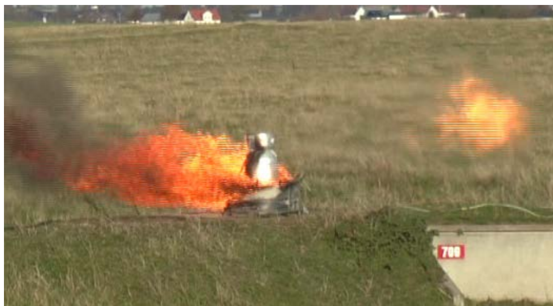
Figur 47. Säkerhetsventil öppnar och resulterar i flamma mot vindriktning(flamma till höger).
