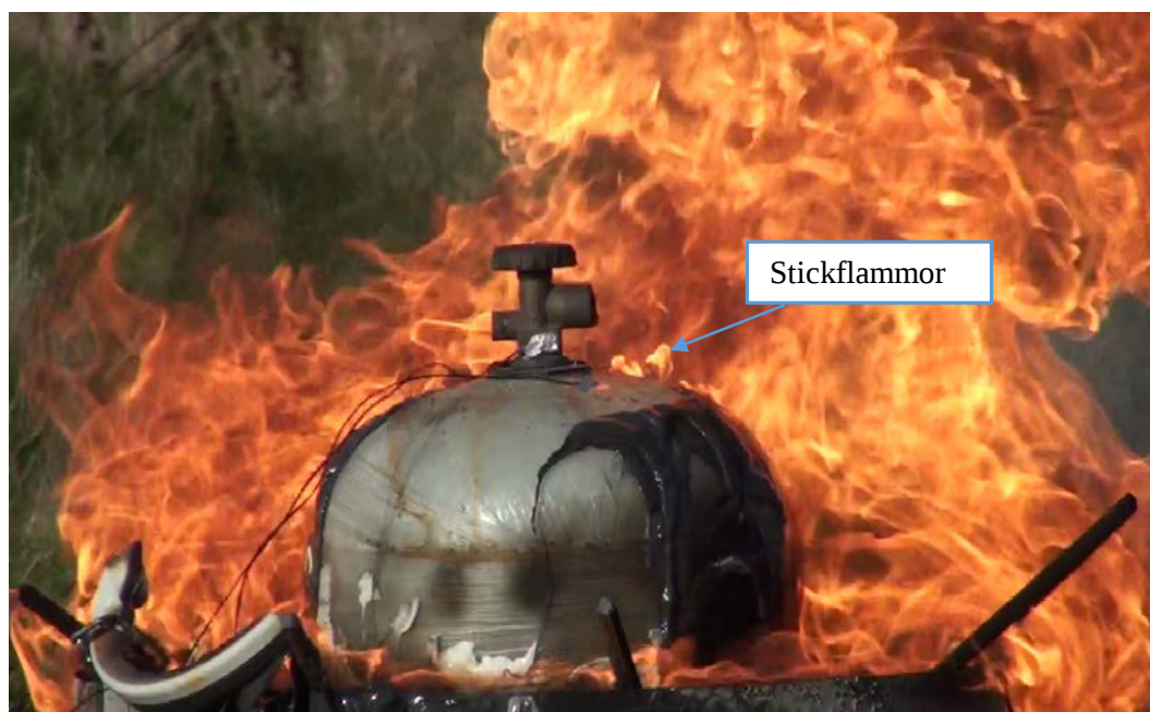
Figur 32. Stickflammar från behållarens övre del.
