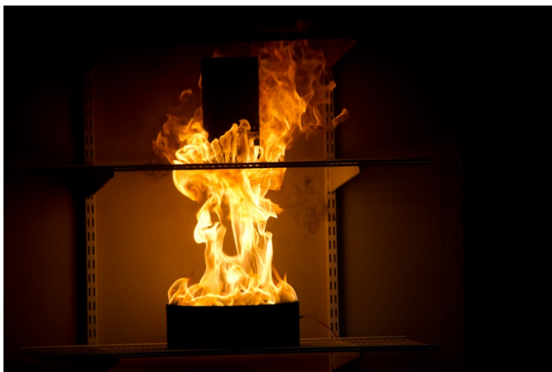
Figur 16. Aerosolbehållare exponeras för brinnande brandfarlig vätska.
