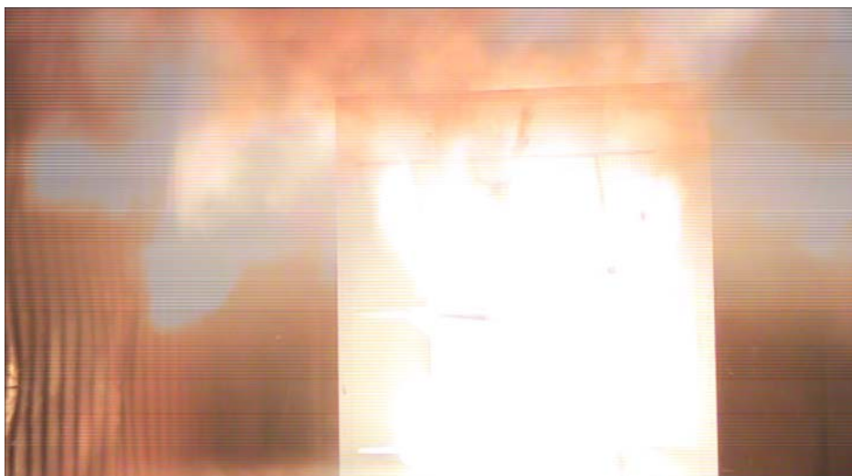
Figur 18. Butiksuppställning vid explosion, sekvens I
