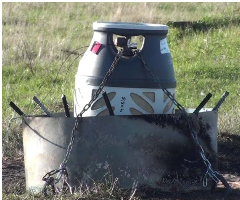
Figur 49. Brandprovning 4 med gasolbehållare PC5
