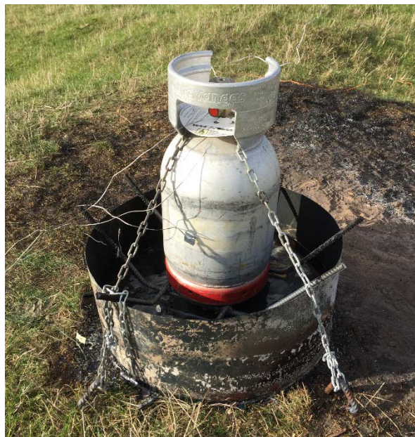
Figur 9. Försöksuppställning 3 – Brandprovning av större gasolbehållare
