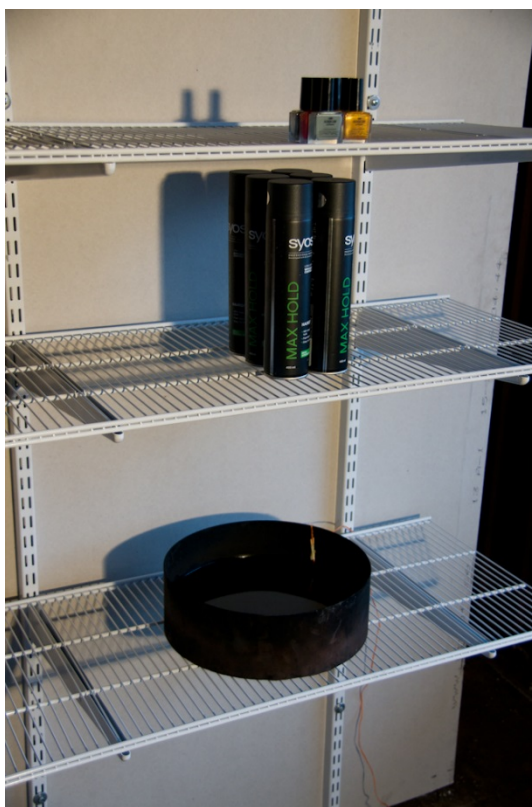
Figur 8. Ingående komponenter i brandprovningen med butiksuppställningen.
