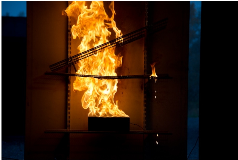
Figur 26. Butiksuppställning just efter explosion av aerosolbehållare.
