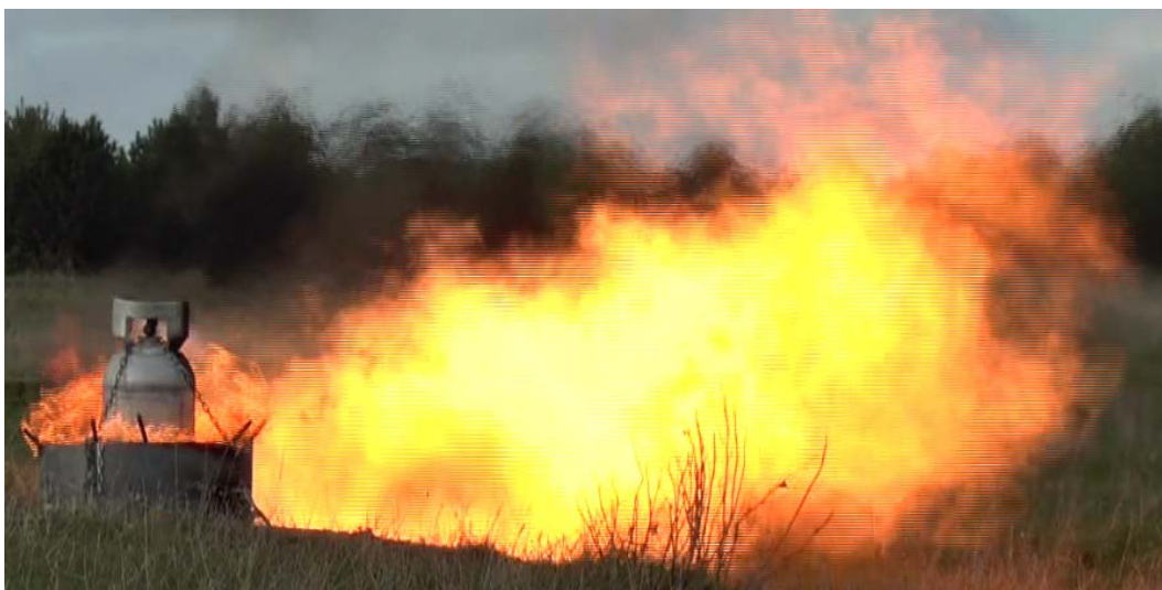
Figur 43. Jet flamma från hål för smältsäkring.
