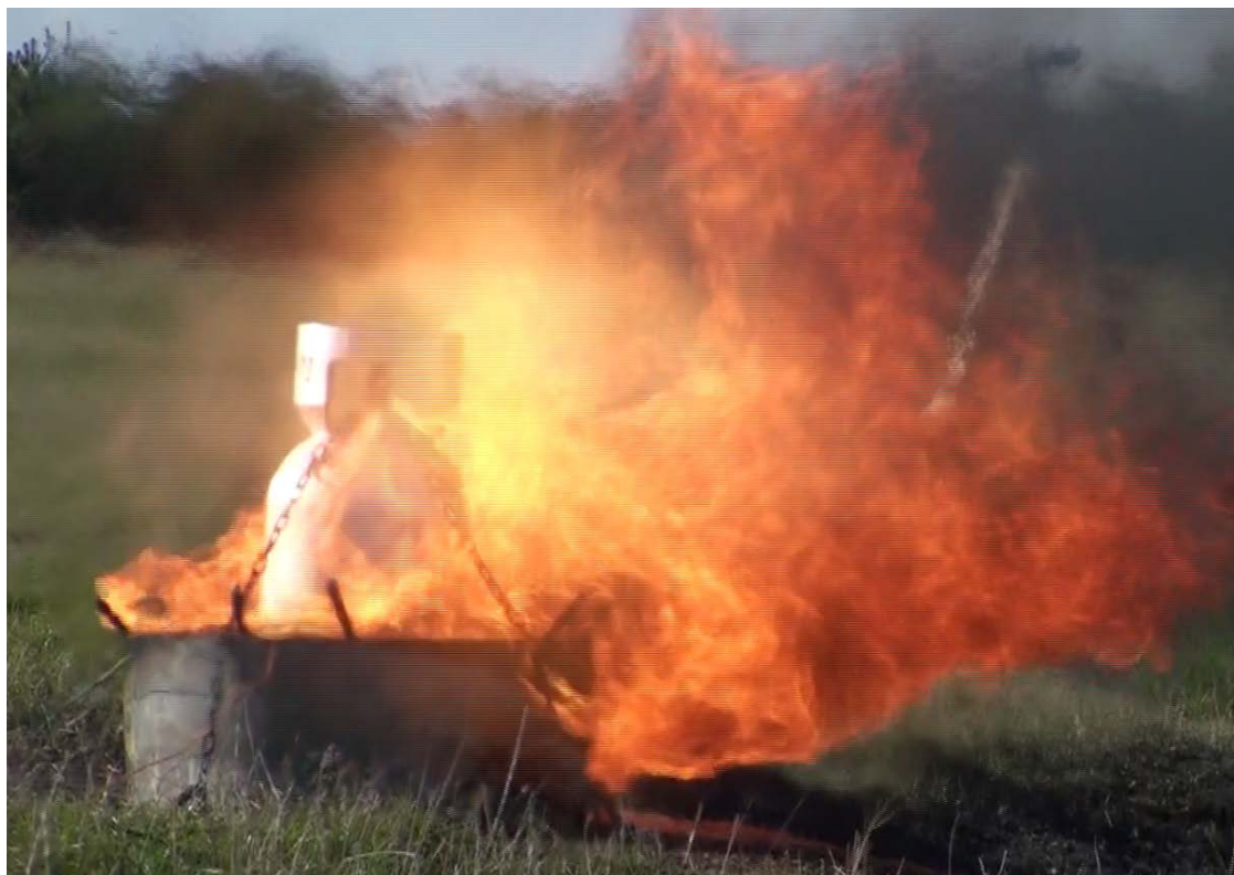
Figur 46. Säkerhetsventil öppnar och gasen antänds(ljusbula flamman vid behållarens övre del)
