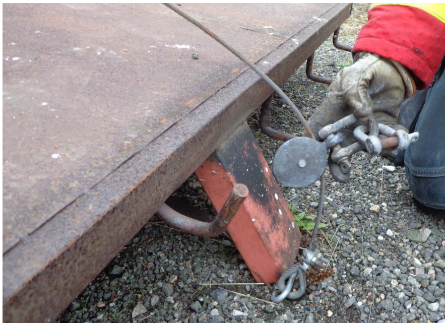
Figur 25. Rundjärn närmast i bild böjdes av tryckvågens påverkan på gavelluckan.
