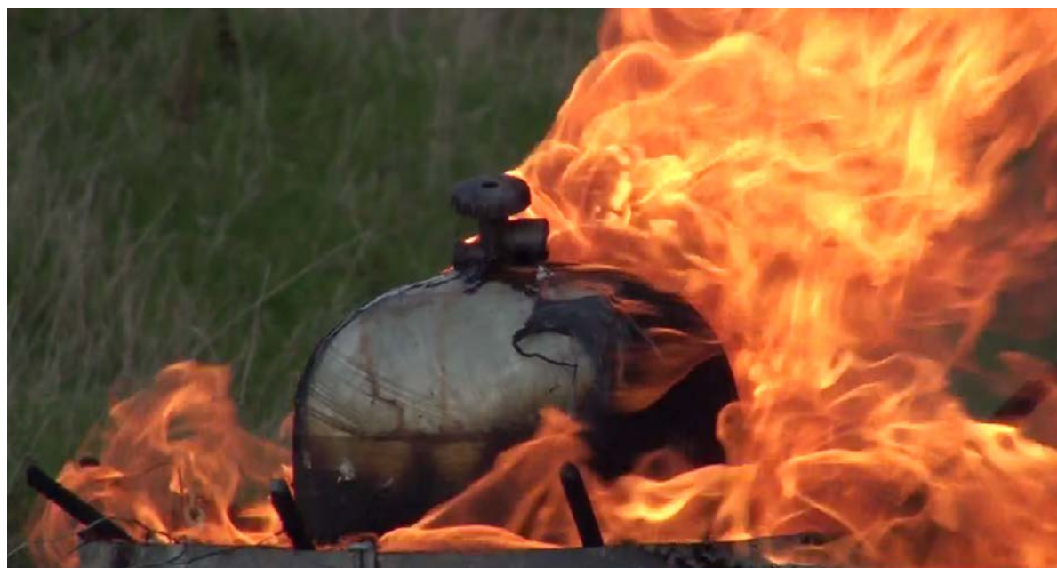
Figur 34. Anslutningsdelen vilar på behållaren.
