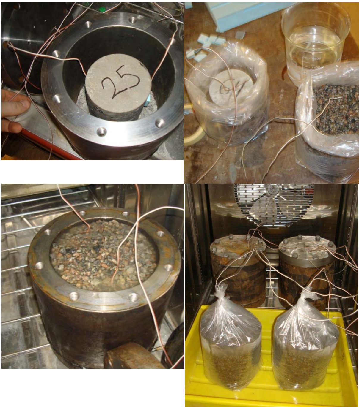
Bild 2. Prover testades i en stålbehållare (tv) eller i en plastpåse (th). I båda fallen var proverna omgärdade av grus och vatten. (Pålbrink & Rydman, 2013)
