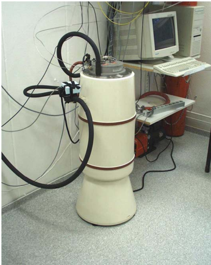
Bild 7. Lågtemperaturkalorimeter Setaram BT 2.15(tv) och provhållaren och prov (th).
