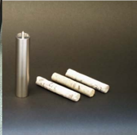
Bild 7. Lågtemperaturkalorimeter Setaram BT 2.15(tv) och provhållaren och prov (th).
