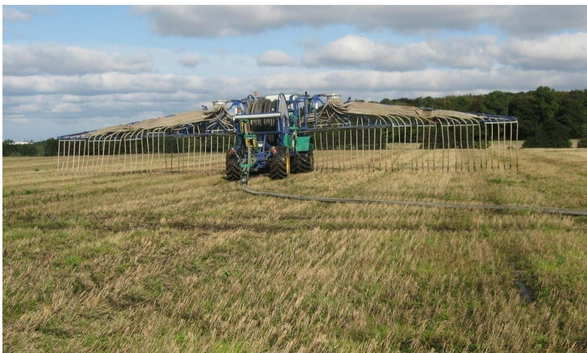
Figur 2: Självgående spridare med matarslang (Tornerhjelm, 2008)
