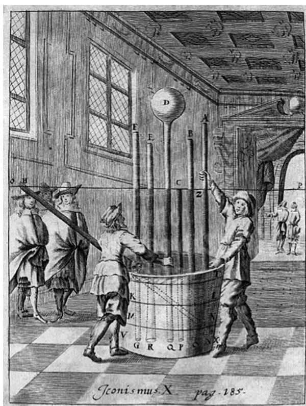
Fig. 3. Vincenzo Vivianis och Evangelista Torricellis berömda experiment i Florens med kvicksilverpelare i glaströr våren 1644. Ur Gaspar Schott, Technica Curiosa (1664).
