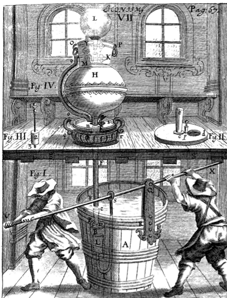
Fig. 4. von Guerickes luftpump i hans hem hanterad av två medhjälpare som är dolda under golvet. Notera att pump och ventiler är nedsänkta i vatten för att minska läckage. Ur Gaspar Schott, Technica Curiosa (1664).
