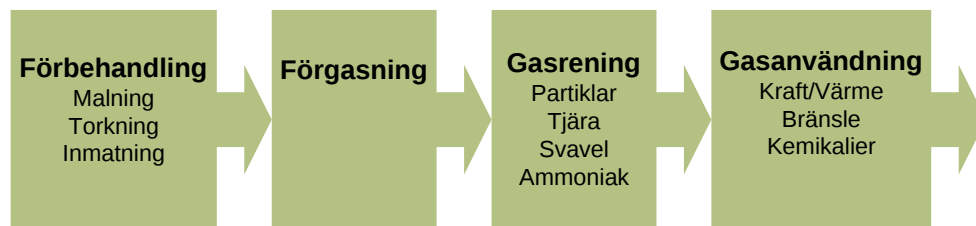
Figur 9. Schematisk översikt av förgasning av biomassa och dess användning.
