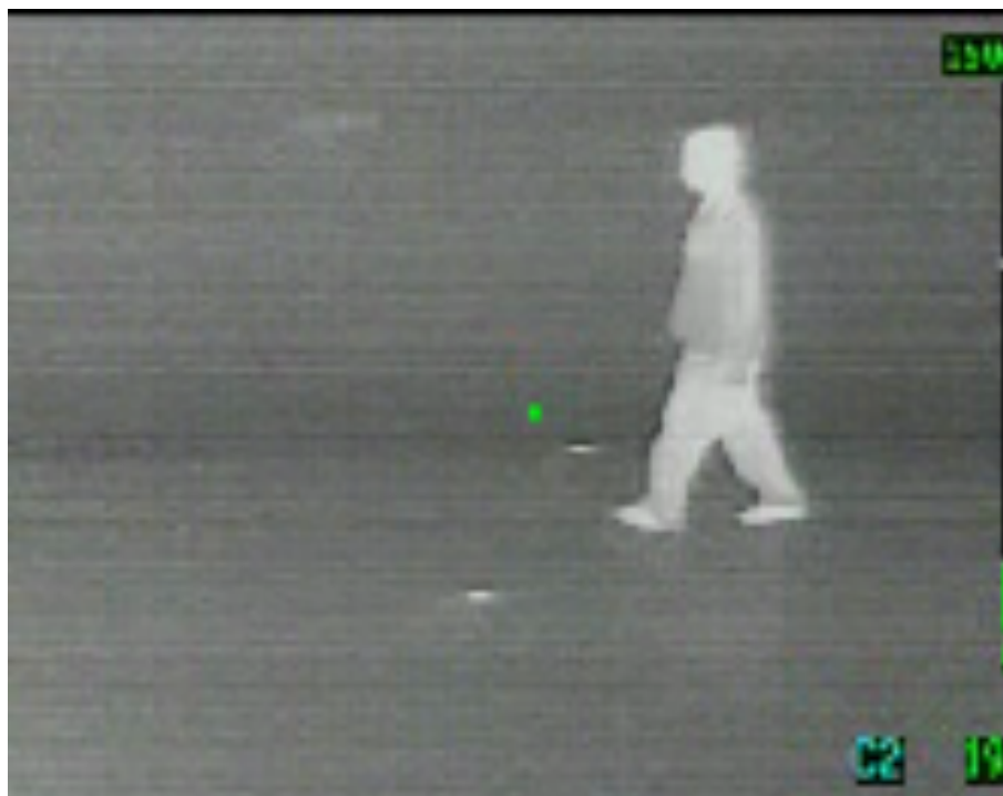
Figur 10. Bild från inspelning gjord med värmekameran. På bilden syns en försöksperson samt två värmekuddar.
