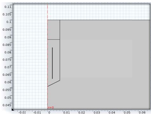
Figur 21. Geometrisk avbildning av borrhålsmätning med aktiv del av Vaisala-sensor, betong, rörvägg och innesluten luftvolym.
