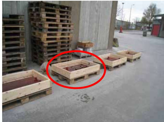
Figur 7. Provformar bestod av lastpall med sarg.
