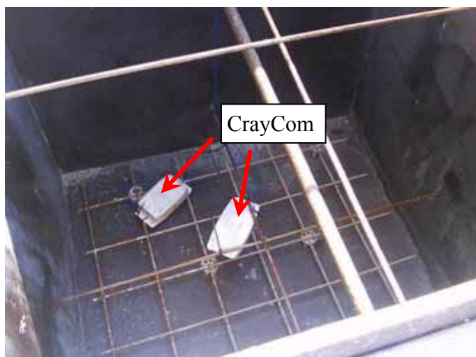
Figur 31. Placering av CrayCom på armeringsjärn.
