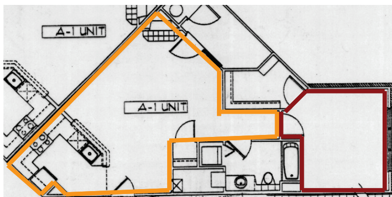
Figur 29 Exempel på rumsgeometri som inte kan beskrivas med rätblock.
