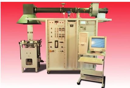
Figur 3 Tewarsonapparaten (bild FTT, med tillstånd av FTT)
