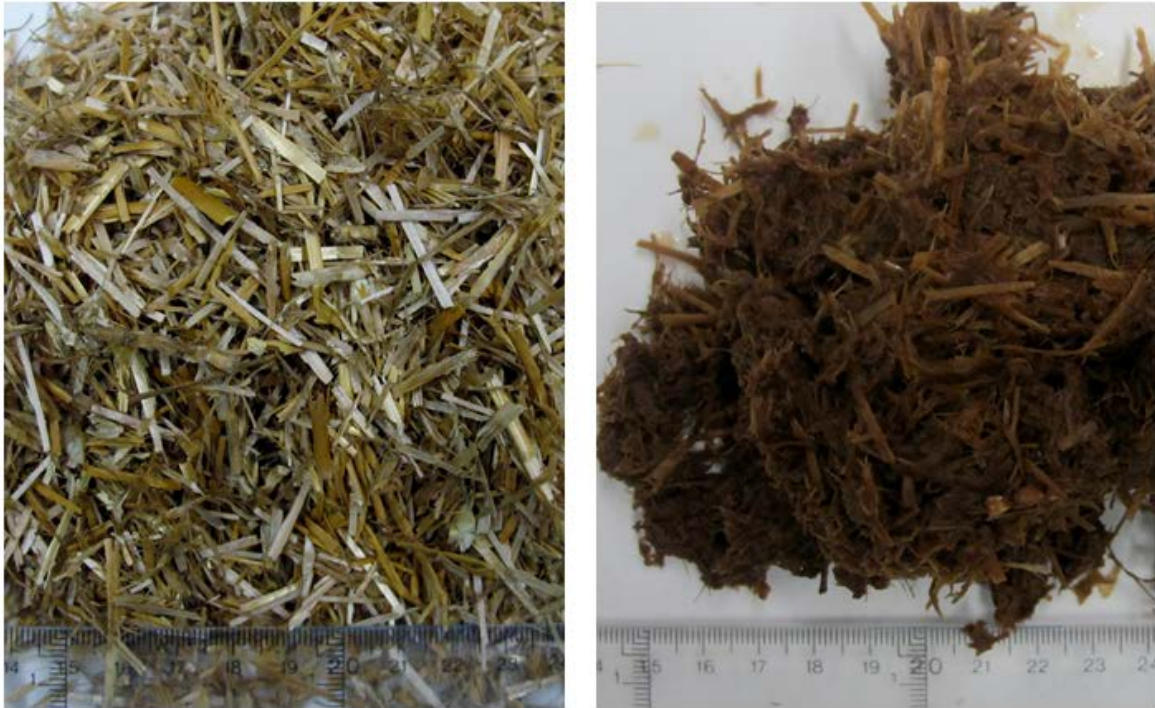
Figur 3. Exempel på struktur för hackad vetealm före och efter syrakatalyserad ångförbehandling (Foto: Christian Roslander).
