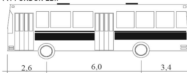
Figur 2-1 Mått och prestanda för typfordon LBn (Vägverket, 2004)
