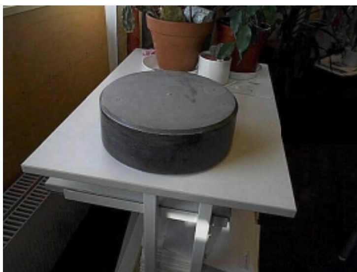
Figur 4-3 Block av bentonitpulver pressat under 100 MPa tryck [45].
