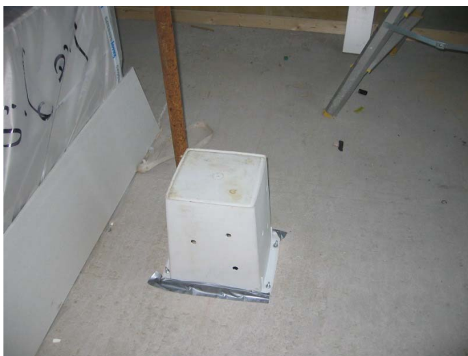
Figur 19. En skyddande plastkåpa monterades för att skydda mätutrustningen.
