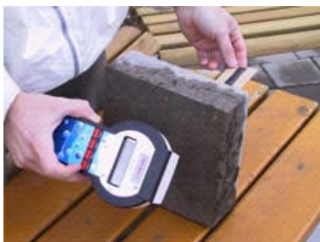
Figur 1. Trådlös fuktmätning genom en platta av betong. Den magnetoelastiska sensorn läses av med en handhållen detektionsenhet.
