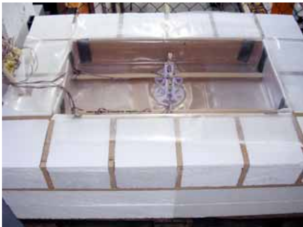
Figur 3a. Plastad gjutform med värmerör.
