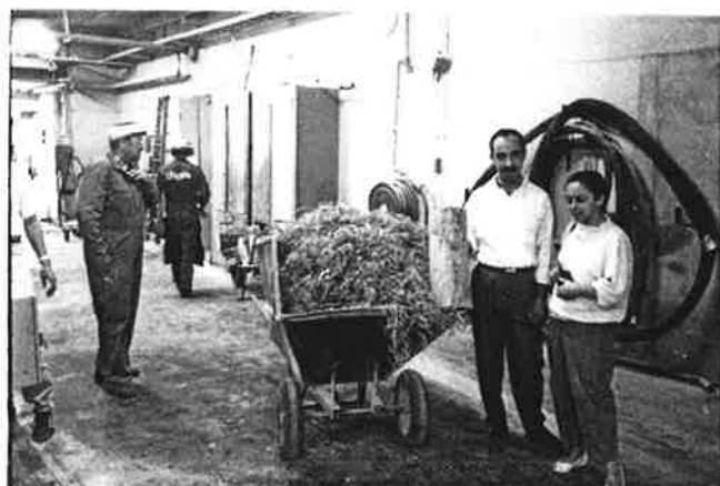
Fig 10. Hyvling av eucalyptus camaldulensis vid T-produkternas fabrik i Österbymo (vänster). Mängden ull som man fick ut av en och en halv stock var drygt en kubikmeter (höger).
