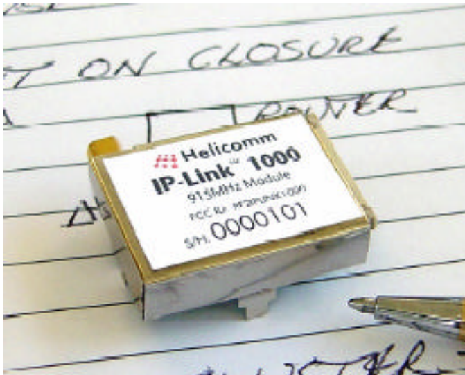
Figur 19. Helicomms IP-Link 1000 är en ZigBee-baserad radiomodul med ingångar för sensorsignaler.
