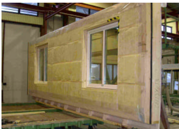
Figur 2. Plant byggnadselement i form av hel vägg.
