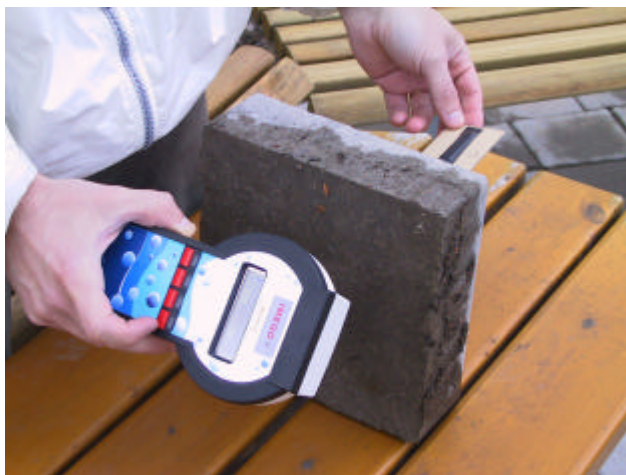
Figur 26. Imegos system för trådlös mätning av fukt med små billiga magnetoelastiska sensorer.
