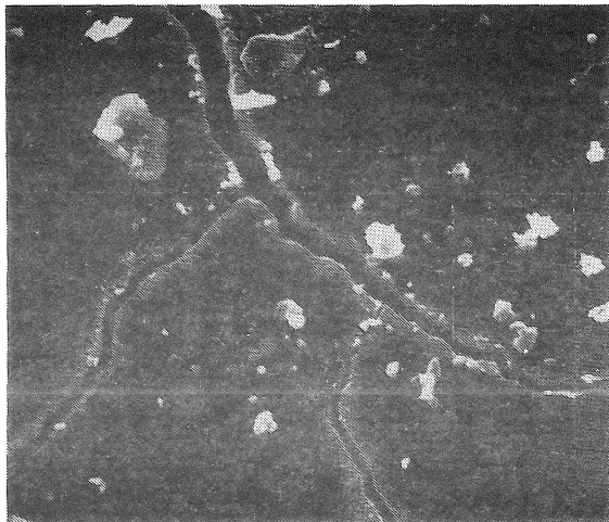
FIG 48 Yta av polysulfidbaserad fogmassa UV-bestrålad 21 dygn. Förstoring: 600x. Foto: Zoologiska institutionen, Lunds universitet.
