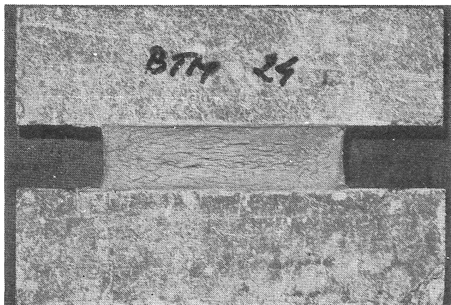
FIG 62 Provkropp av "Material 1" som utomhus-exponerats ca 7 månader.
