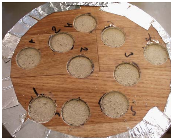
Figur 6.1 - Förprov 75RSPvV3 med RF = 91.5% (dragbrott mellan lim och betong (adhesion)).
