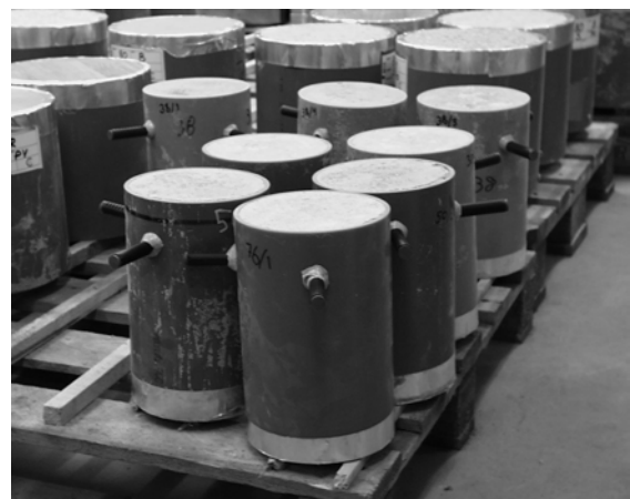
Figur 3.7 - Vid fuktmätningen borrades två mäthål tvärs provkroppen på avståndet 50 mm från ytan.
