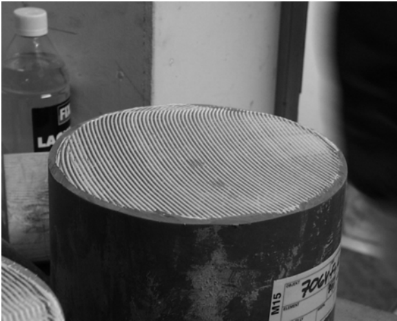
Figur 3.1 - Lim lades 5 min. före ytbeläggning.
