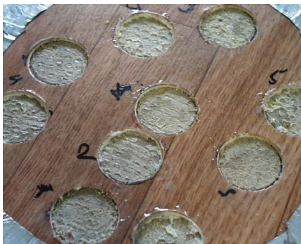
Figur 6.2 - Förprov 37RSPvLV3 med RF = 75% (dragbrott i limmet (kohesion)).
