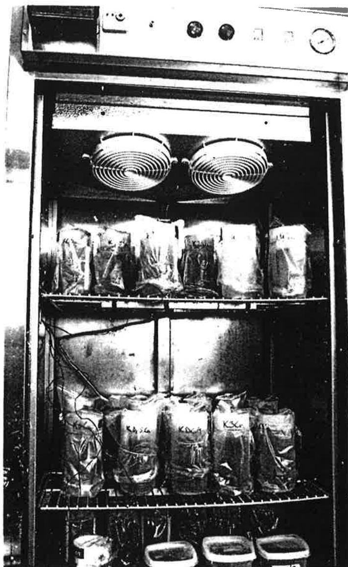
Figur 3.5. Avskalningsförsök. Bägare med prover placerade i frysskåp.
