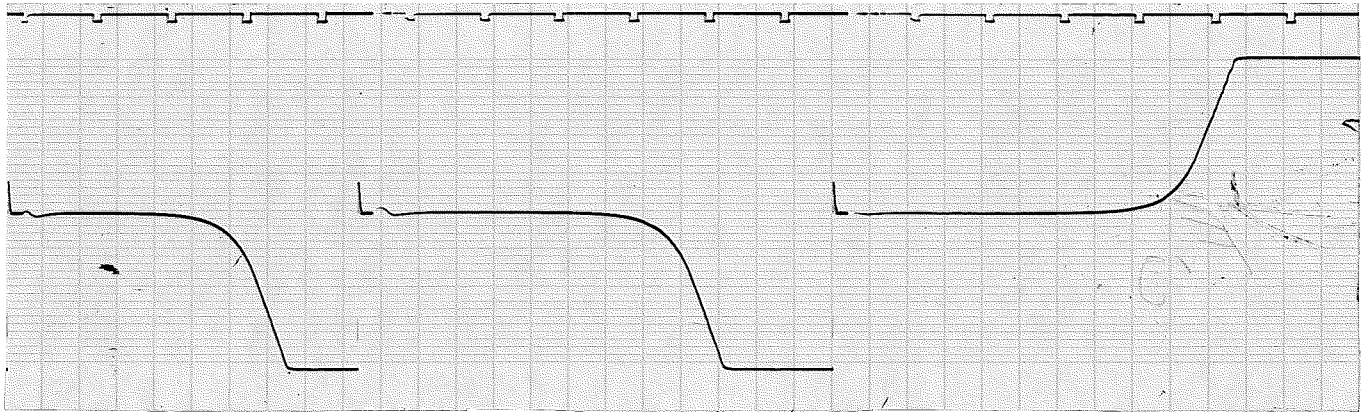
Fig. 5.4 Analogmaskinsimulering av andra-ordnings modellen med g=9.81 \text{ m/s}^2 . Lutningsvinkeln v_2 ges som funktion av tiden.
