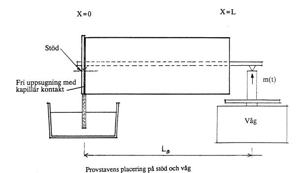
Provets uppsugande yta är placerad i samma vertikalplan som det vänstra stödet så att det uppsugna vattnet inte ger momenttillskott.Endast fukttransporten i materialet ger moment.
