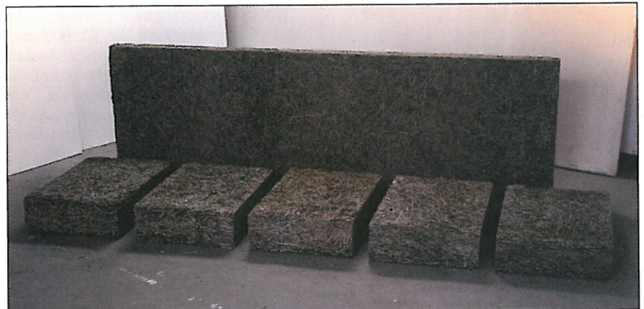
Figur 1. Träullsplatta sågad till block.
