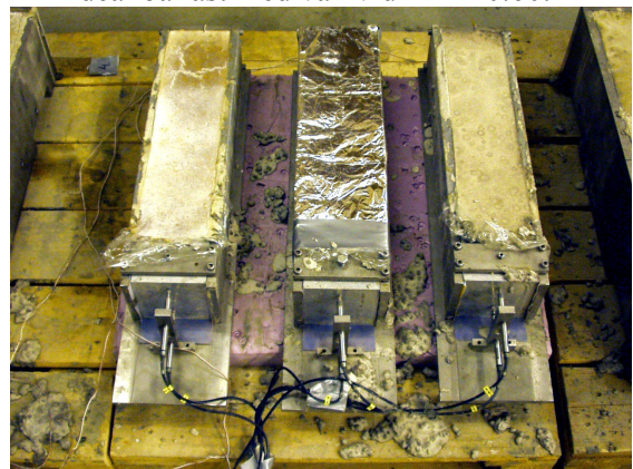
Figur 4.38 – Betongrest på högra mätblocket.
