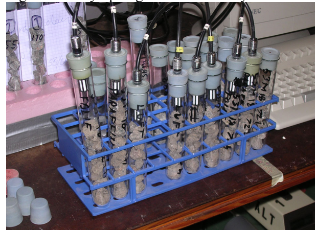
Figur 3.7 - Relativ fuktighet i betongfragment.
