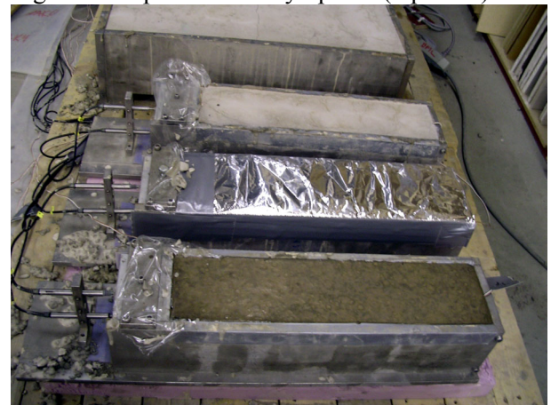
Figur 3.6 - Krympning 20-70 mm från ytan.
