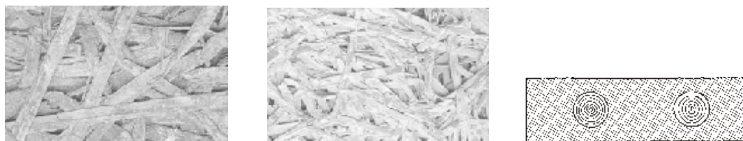
Fig. 5.1 Différents types de panneaux de laine de bois : panneau isolant (à gauche) et panneau acoustique (au milieu). A droite, un panneau autoporteur renforcé de rondins
