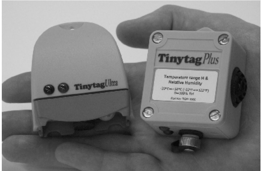
Fig. 3.12 Tinytag Ultra (à gauche) utilisé pour les mesures à l'intérieur du bâtiment (dimension : 8 × 8 cm) et Tinytag Plus (à droite) utilisé pour les mesures à l'extérieur (dimension : 8 × 8 cm)
