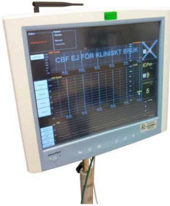
Övervakningsapparaten som används till att övervaka patientens blodflöde i hjärnan.
