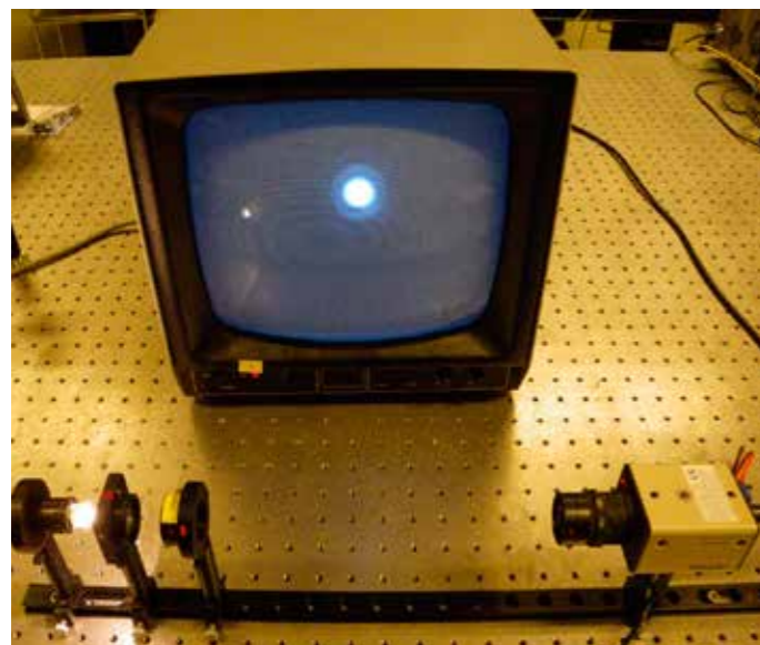
Bild 1(a): Foto av uppställningen med lampa, iris, filter och kamera. Det som ser ut som ett objektiv på kameran är i själva verket bara pinhållet monterat framför ett antal distansringar för att få ett visst avstånd mellan pinhållet och kamerans sensoryta.
