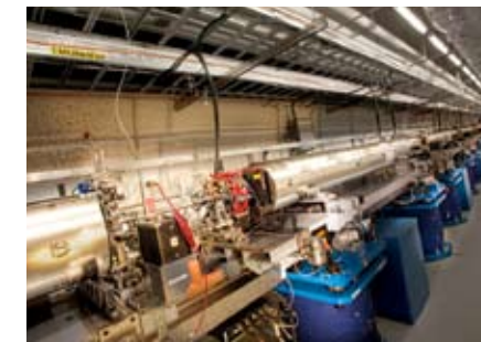
Den 120 meter långa undulatorn vid LCLS.
