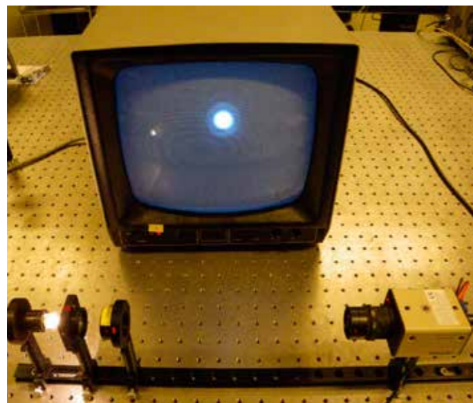
Bild 1(a): Foto av uppställningen med lampa, iris, filter och kamera. Det som ser ut som ett objektiv på kameran är i själva verket bara pinhållet monterat framför ett antal distansringar för att få ett visst avstånd mellan pinhållet och kamerans sensoryta. Nedan bild 1 (b): Schematisk uppställning.
